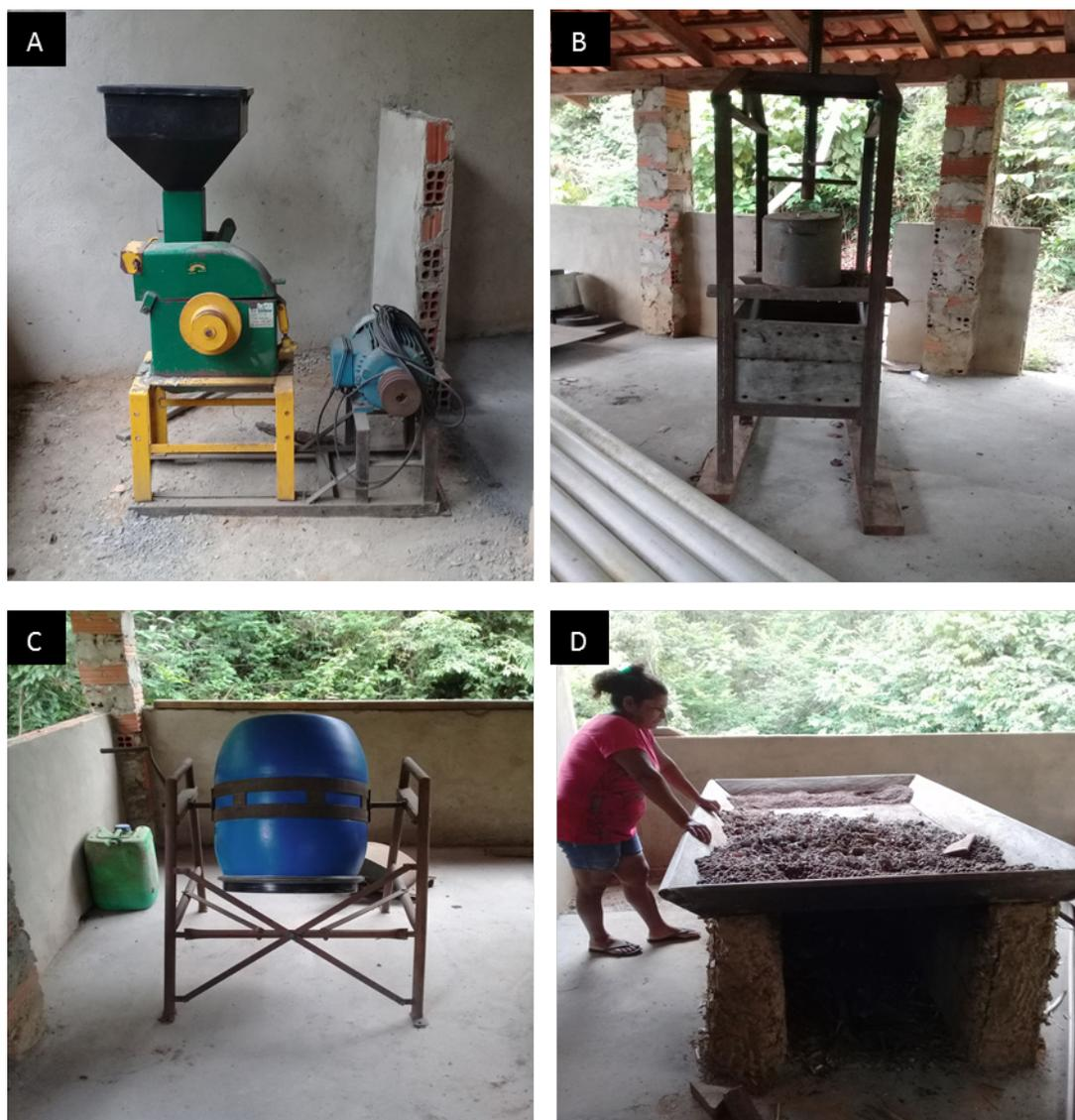
Figura 2 – Equipamentos adquiridos para o funcionamento da minifábrica de ração da comunidade de Anã. A) triturador; B) prensa; C) misturador; e D) forno. Fotos: Liliâne de Araújo Castro.
