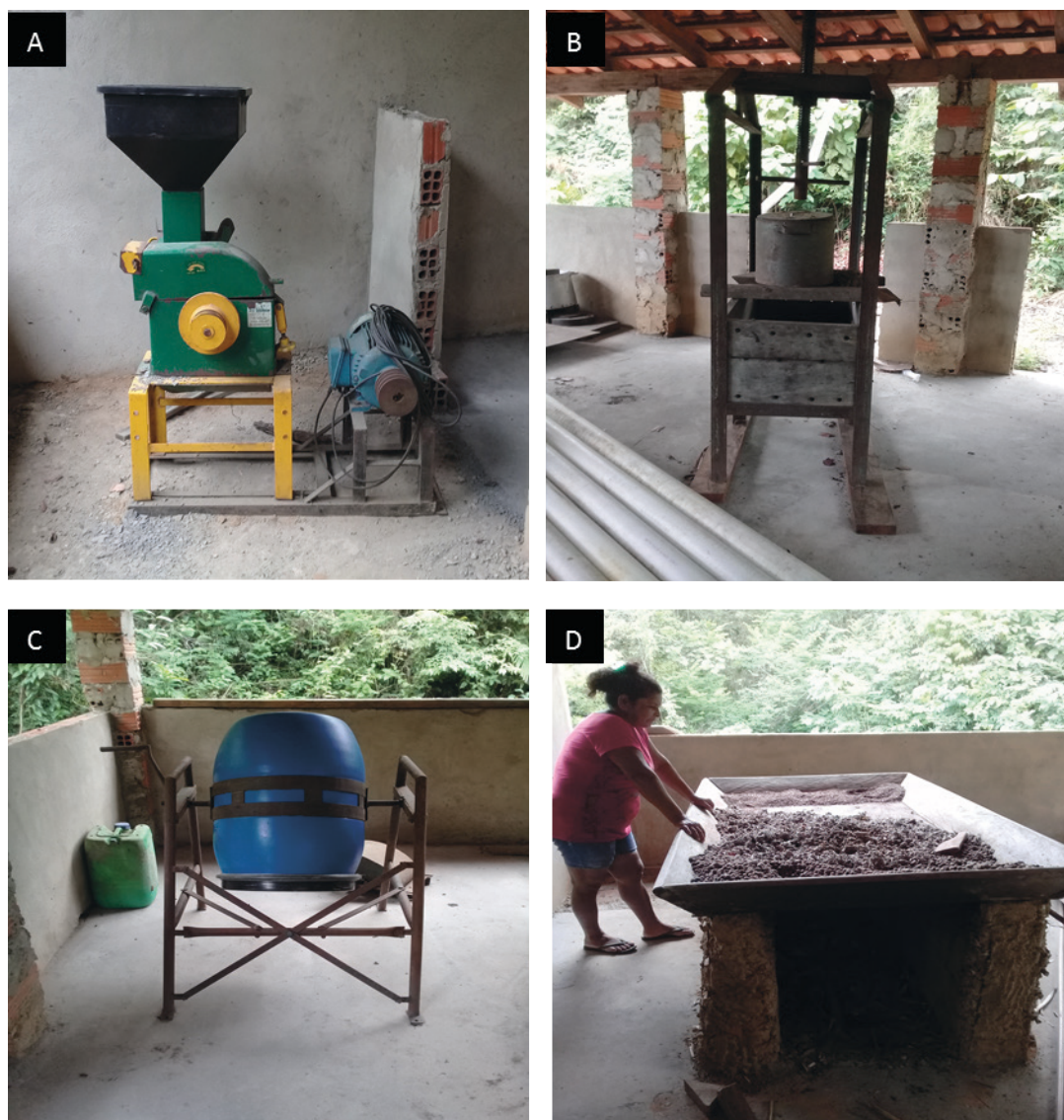
Figura 2 – Equipamentos adquiridos para o funcionamento da minifábrica de ração da comunidade de Anã. A) triturador; B) prensa; C) misturador; e D) forno. Fotos: Liliane de Araújo Castro.
