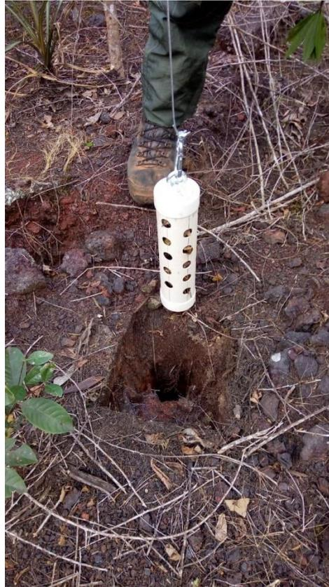
**Figura 4:** Introdução das armadilhas em furos de sondagem.
