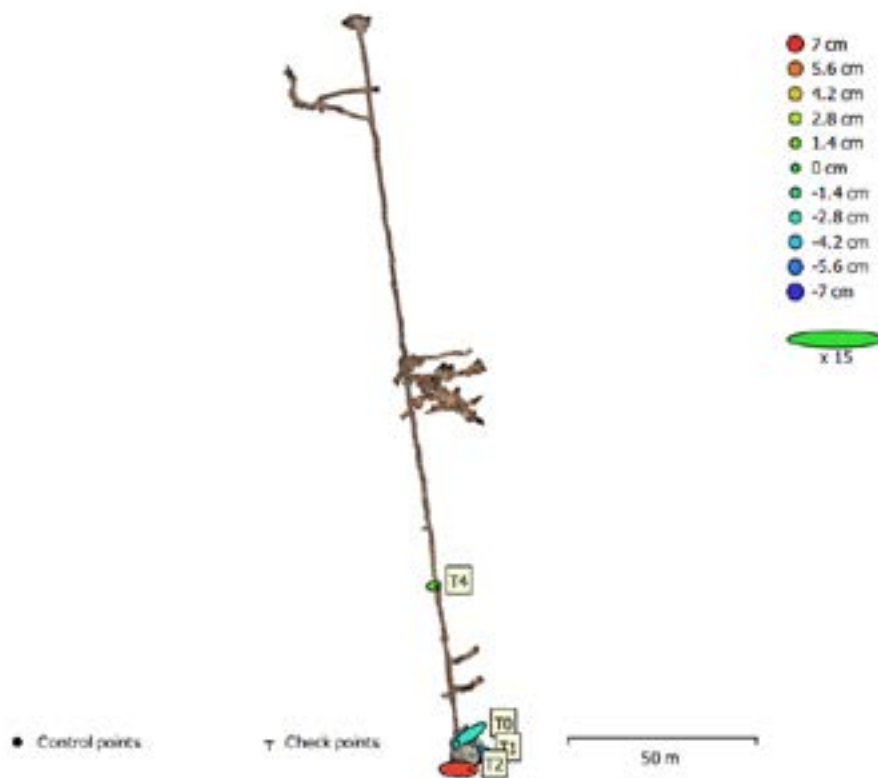
Figura 8 – Erro médio quadrático relativo dos pontos de controle e posicionamento do modelo 3D da Mina do Veloso emitido pelo relatório de processamento do software Agisoft Metashape.
