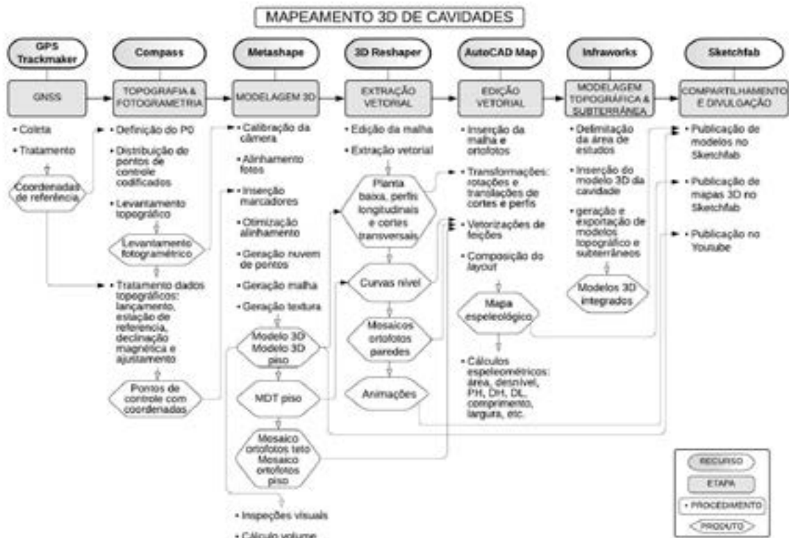
Figura 2 – Fluxo de trabalho para geração de mapas espeleológicos a partir de modelos fotogramétricos.
